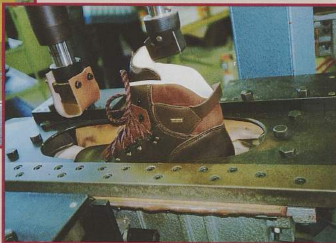
Lis přitlačuje podešev ke svršku boty - uvnitř boty je kopyto, které spolu s botou absolvovalo společnou pouť montážní dílnou.
