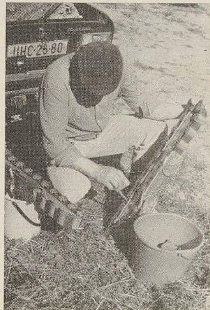
Mazání travních lyží — bez vosků a parafinů. Z olejničky kape obyčejný stolní olej.
