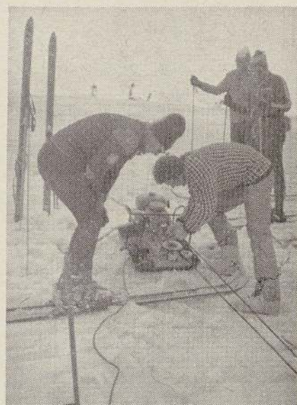
Předseda úseku sportovního lyžování VSL ČŮV ČSTV, Igor Houdek, sleduje napojování lana na motor vleku
