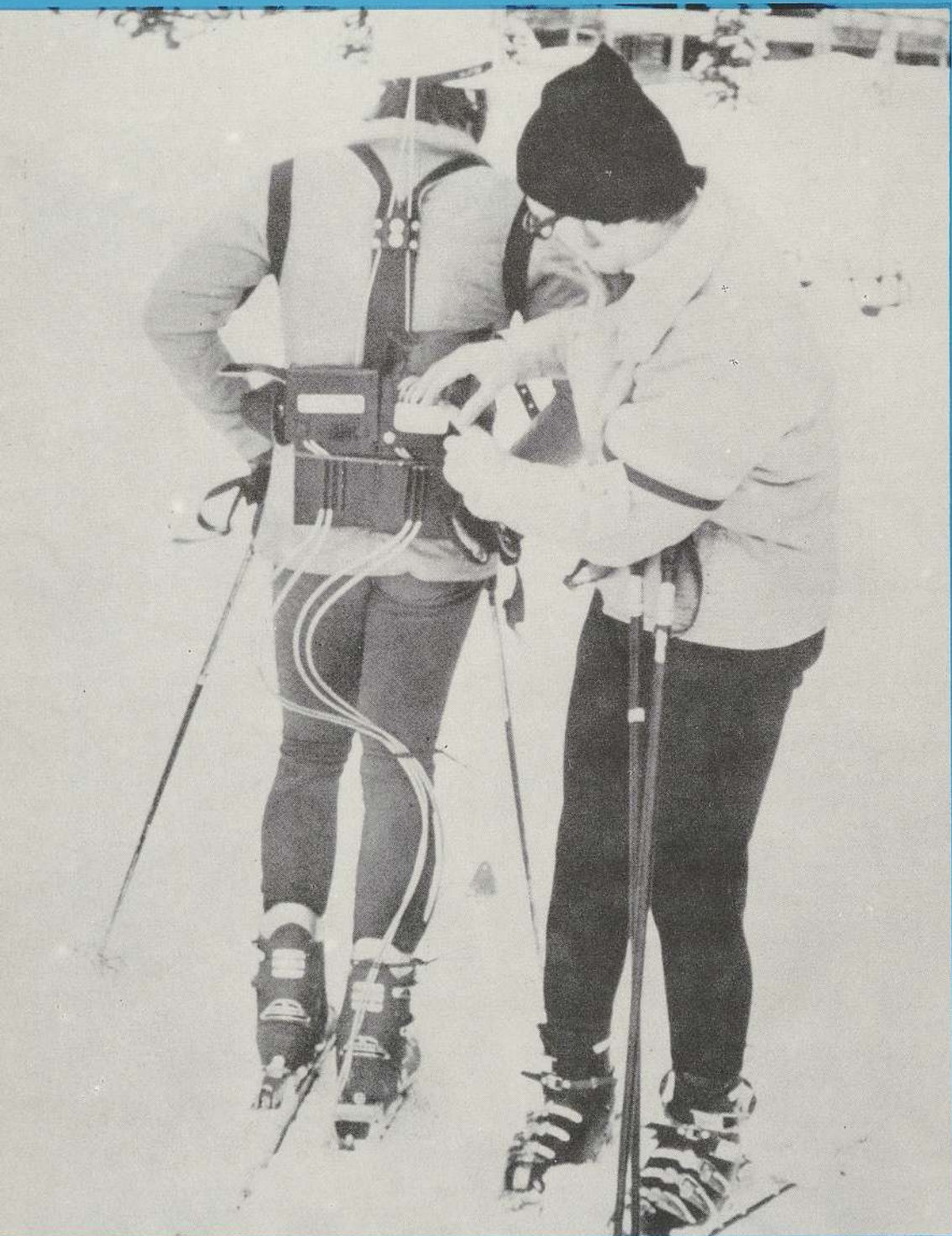
Technika významně pomáhá i v lyžování. Sjezdař na zádech s vysílačem, připojeným na přístroji registrujícím otřesy, kterým je vystaveno vázání. Údaje se pomocí telemetrie přenášejí na registrující přístroj u cíle.
